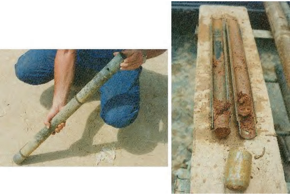
Figura 1. Aspecte que presenta el SPT (esquerre) així com la mostra que es recull al seu interior (dreta).
